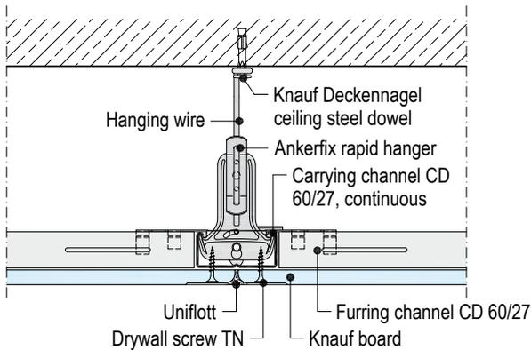
**D113.de-C1 Front edge – flush/Ankerfix**
