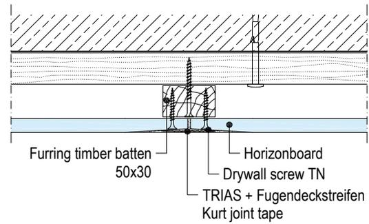
**D112.de-B8 Longitudinal edge – Horizonboard**
